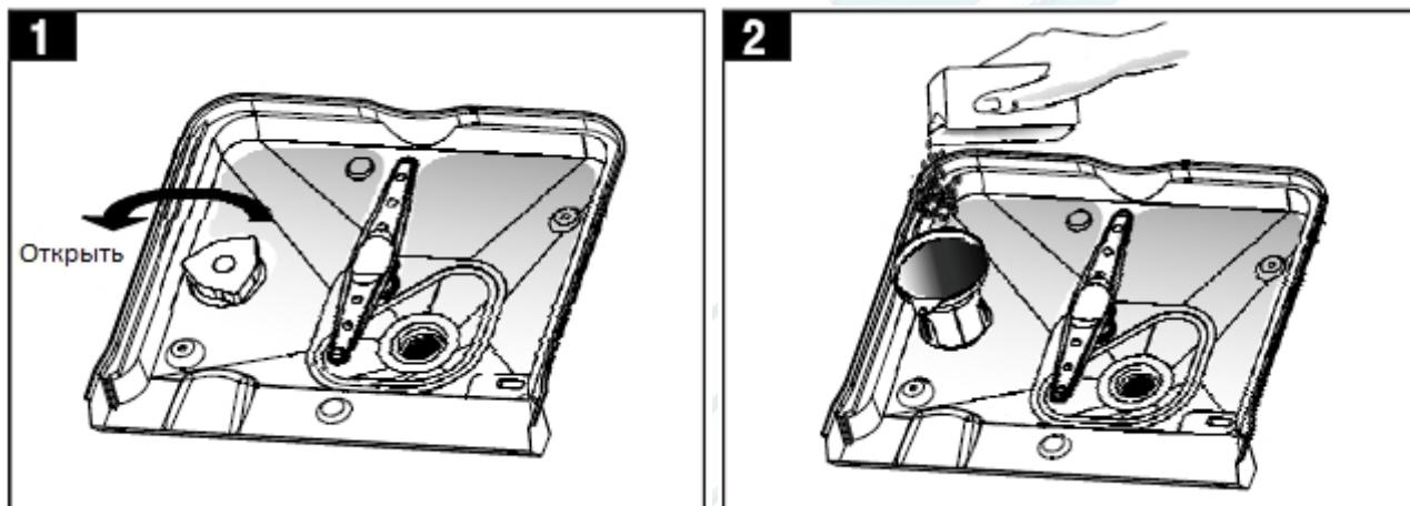
**A** Снимите нижнюю корзину, затем выкрутите и снимите крышку контейнера для соли. **1**
