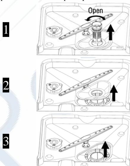
Шаг 1: Поверните фильтр против часовой стрелки, затем снимите его.
