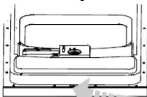
Для очистки краев дверцы, пользуйтесь только мягкой влажной салфеткой. Для предотвращения проникновения воды в замок и электрические компоненты, не пользуйтесь чистящим распылителем любого типа.
